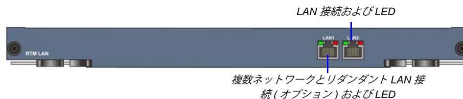
図 1-13 RMX 4000 の RTM LAN リアパネル配置
